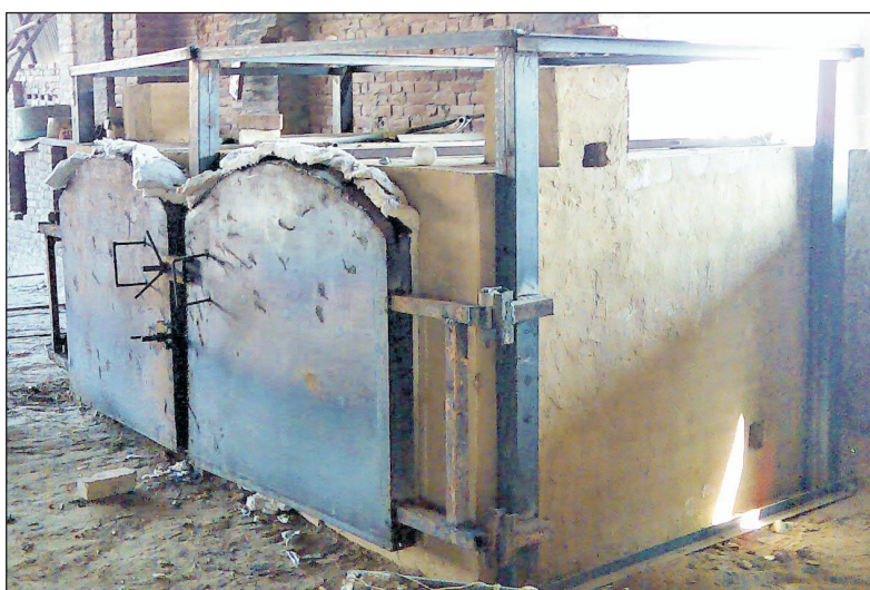
चित्र 60 : लोहे के तापरोधी दरवाजे वाला पॉट कुलीमैन
