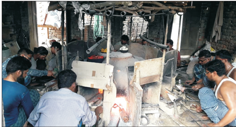
चित्र 10 : कड़ा छाल भट्टी पर खलबूत से चूड़ियाँ बनाते कारीगर
