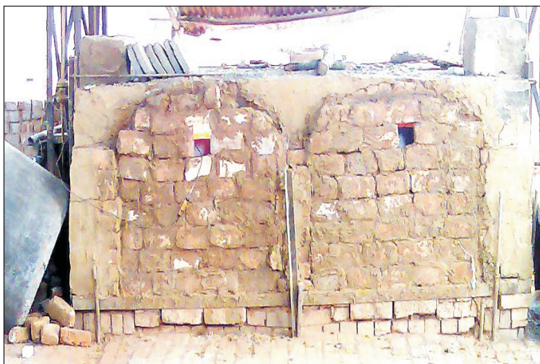
चित्र 59 : ईंटों की पर्दी वाला पॉट कुलीमैन
